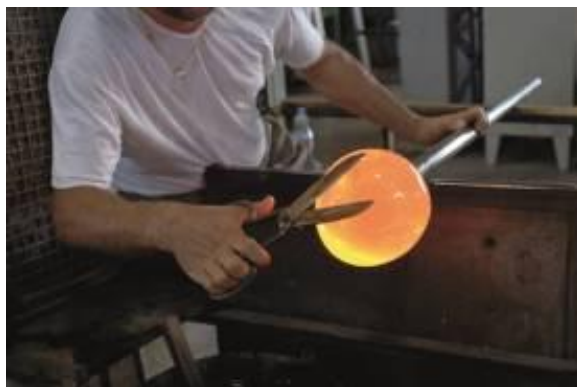
Шар, выдутый через длинную трубочку и надрезанный с одной стороны при помощи железных ножниц
